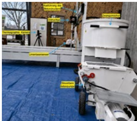
Abb. 1: Misch- und Dosiervorgangskette des Druckprozesses.
