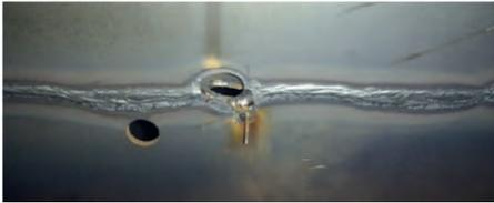
Bild 1 Durchbrand durch zu hohen Wärmeeintrag
