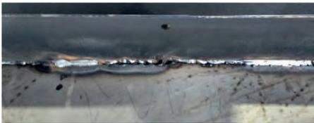
Bild 2 Instabiler Prozess durch zu geringen Wärmeeintrag
