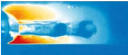
Abbildung 2: Thermografie Bild Aluminium Druckprozess
